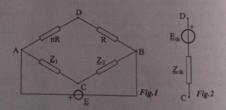
Calculer la force électromotrice  $\underline{E}_{th}$  du générateur de Thévenin équivalent au dipôle de bornes C et D en fonction de n, des impédances complexes  $\underline{Z}_1$  et  $\underline{Z}_2$  et de l'amplitude complexe  $\underline{E}$  de e(t) (figure 2).
