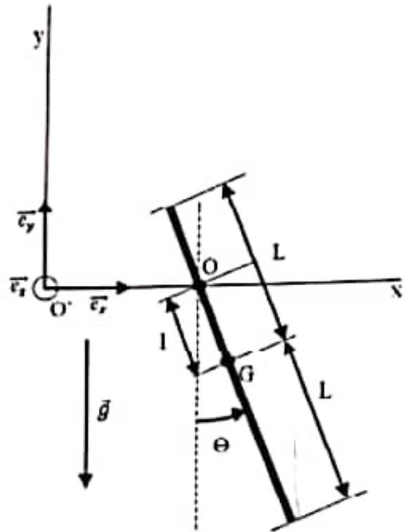
2) Soumise à l'action de la pesanteur, la tige effectue des mouvements d'oscillation dans le plan  $(xO'y)$ , l'axe  $Oz$  est maintenu horizontal et fixe. On repère sa position par l'angle  $\Theta = \Theta(t)$ . La liaison en  $O$  est supposée parfaite, la réaction d'axe en  $O$  se limite à une force  $\vec{R}$  agissant en  $O$ .
