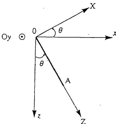
2) La tige OA peut tourner sans frottement autour de l'axe horizontal  $Oy$  dans le plan  $xOz$ . Elle n'est soumise qu'à son poids et à l'action du support. La position de la tige est repérée par l'angle  $(Oz, OA) = \theta(t)$  (figure 2). On lance la tige avec des conditions initiales :
